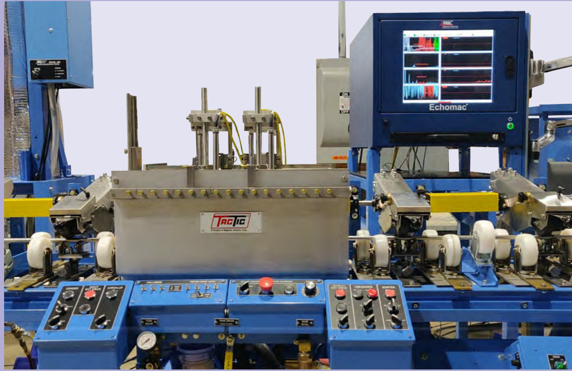
MAC 的 Echomac® FD 6A 超声波检测仪及 TacTic® 标准型“管材旋转”水浸式系统检测钛管。
