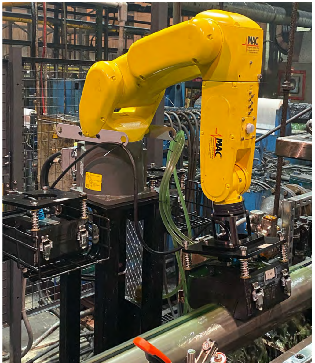
Echomac® PA 相控阵焊缝检测系统热安装在紧邻焊机后的高温区域，用于监控焊管的焊接轮廓。
